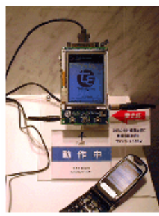
【音声読み上げエンジン】 携帯電話から送信した文章を 読み上げるソフトウェアエンジン
